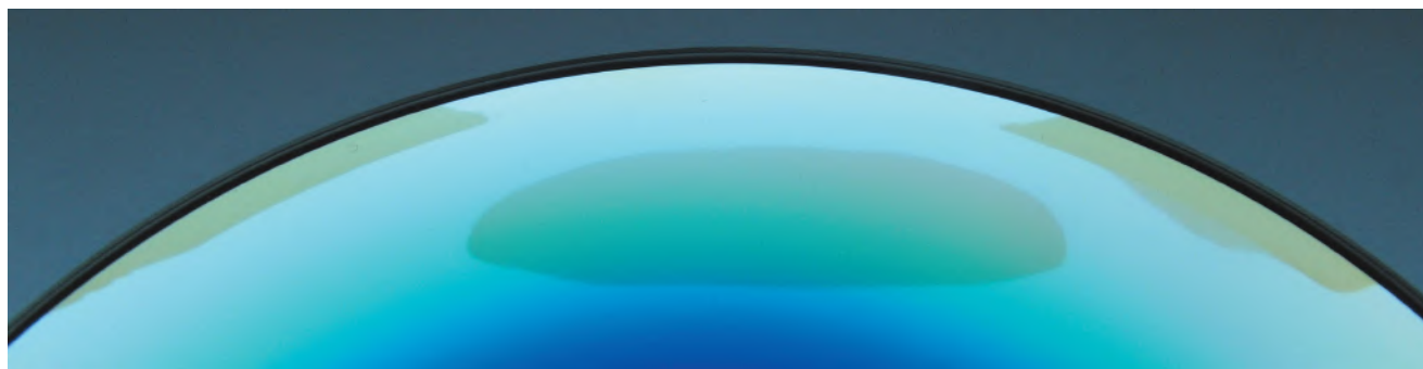
5. ábra. CD-tasak ragasztójának bediffundálása az adathordozóba
